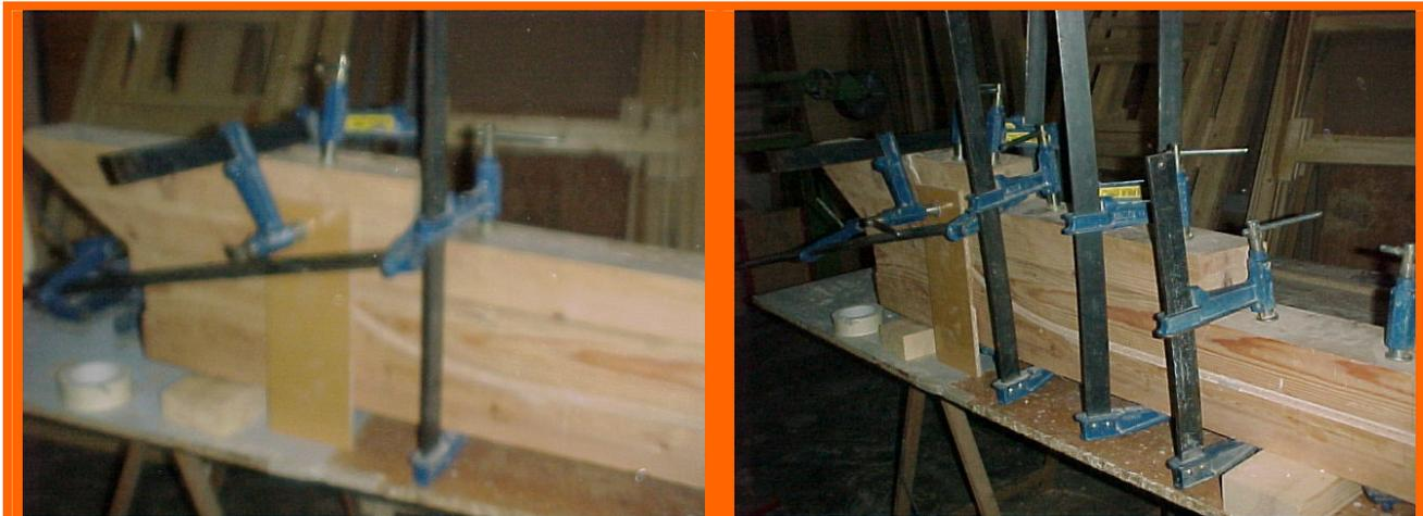
La presión debe ser uniforme a lo largo de todo el molde para evitar deformidades en la madera.
