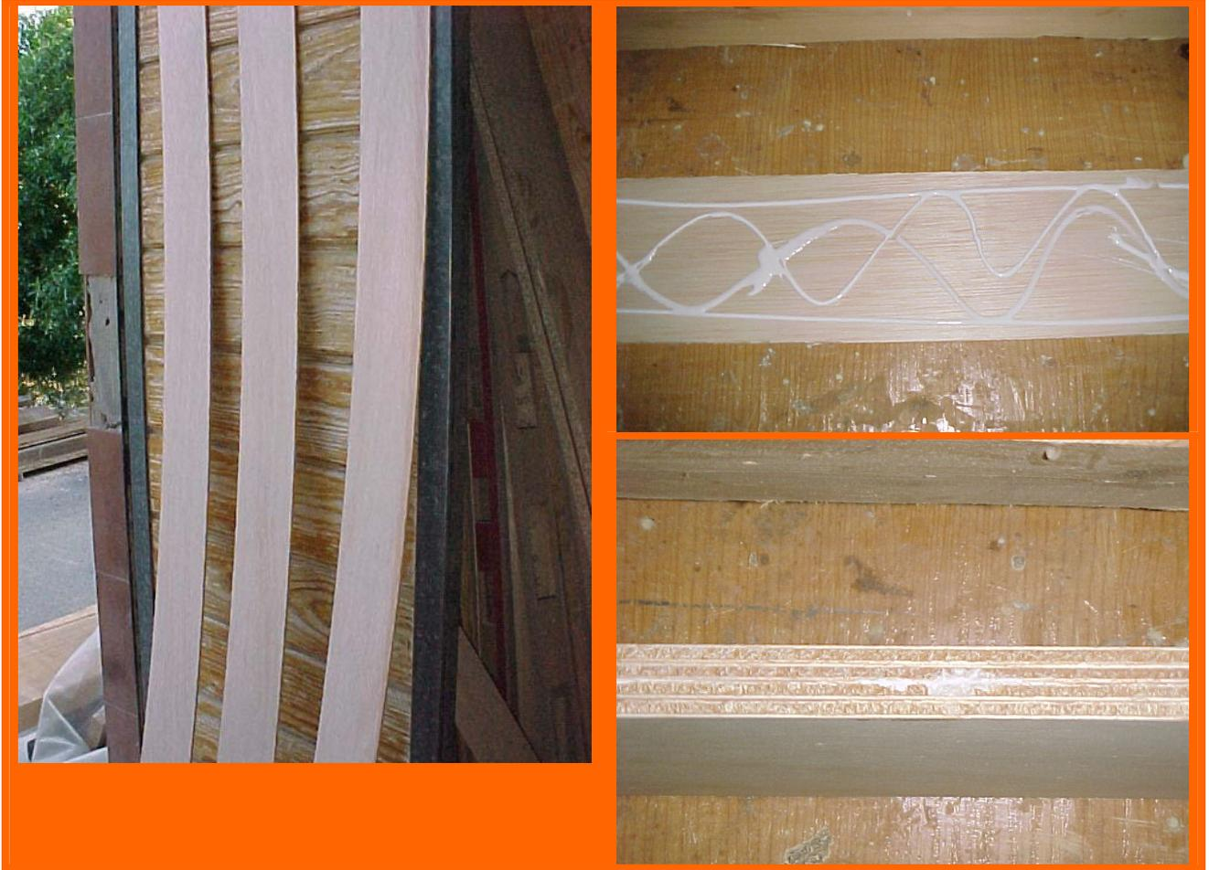
Colocar sobre la base del molde la madera encolada y sobre ésta la parte posterior del molde.
